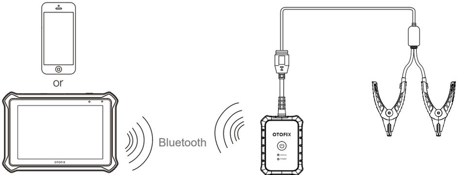
**REMARQUE:** Le BT1 Lite peut être utilisé avec des appareils mobiles et des tablettes OTOFIX D1 et D1 Lite pour effectuer des tests de batterie.
